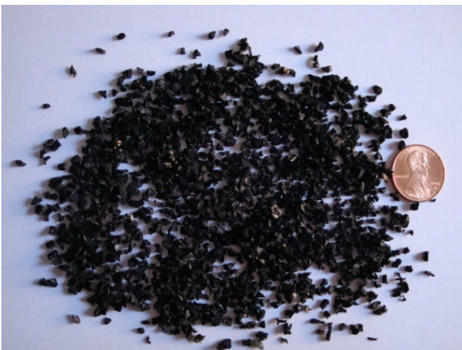
Granos de diferentes granulometrías de goma que pueden variar de 0,5 a 3mm
